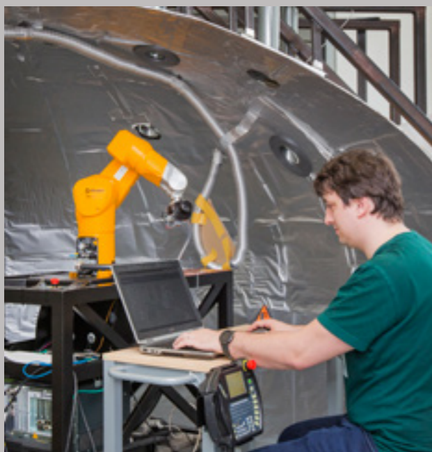
Robot na inspekci víka jaderného reaktoru
